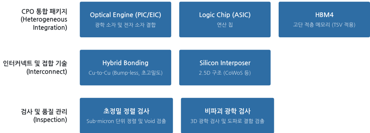
그림 2. 차세대 패키징(HBM4/2.5D)과 CPO의 기술적 접점 및 통합 구조
