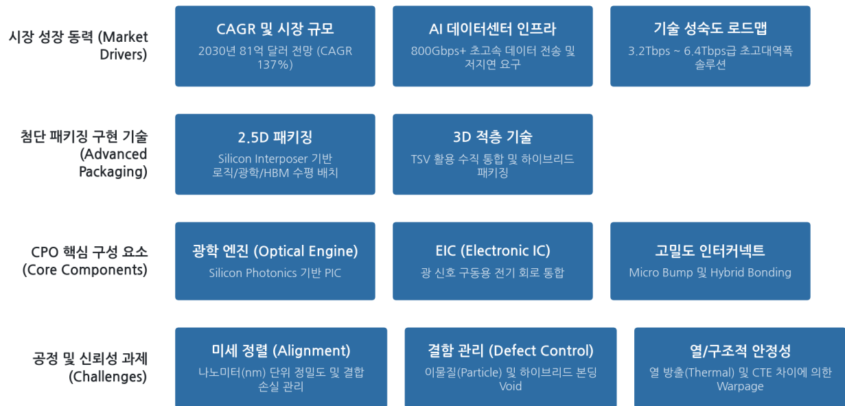
그림 4. CPO(Co-Packaged Optics) 기술 구조 및 시장 동력 분석
