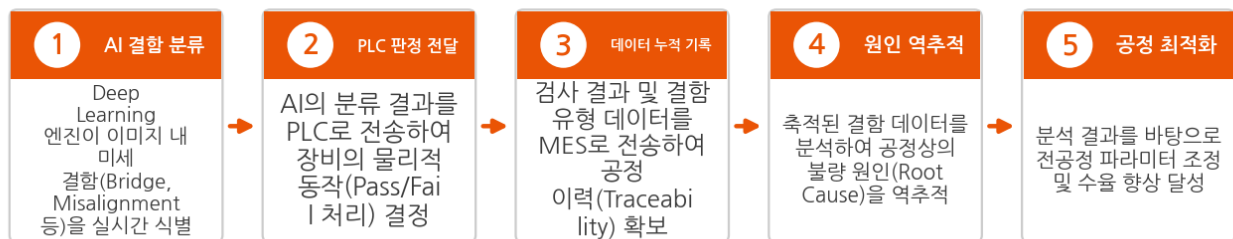
그림 2. AI 결함 판정 및 데이터 환류 루프 (AI Feedback Loop)
