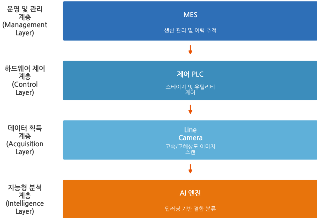
그림 1. 반도체 검사 장비 통합 제어 아키텍처
