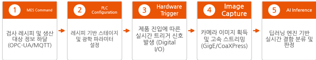
그림 2. MES-PLC-Vision-AI Command Downlink Sequence
