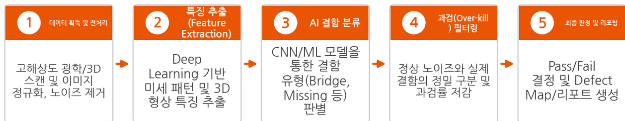
그림 1. AI 기반 AOI 결함 검출 알고리즘 파이프라인
