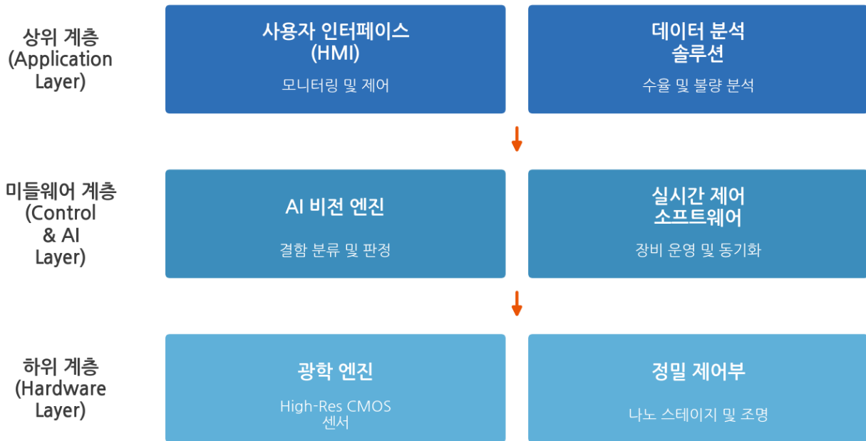
그림 1. 차세대 반도체 패키징 검사 시스템 아키텍처
