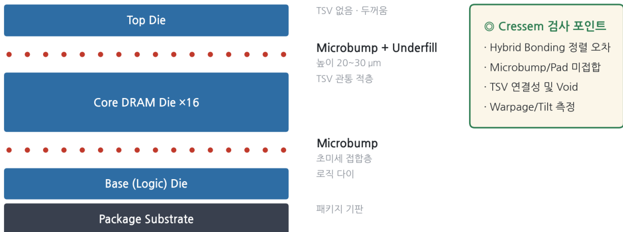
그림 3. HBM4 고단 적층 검사 구조
